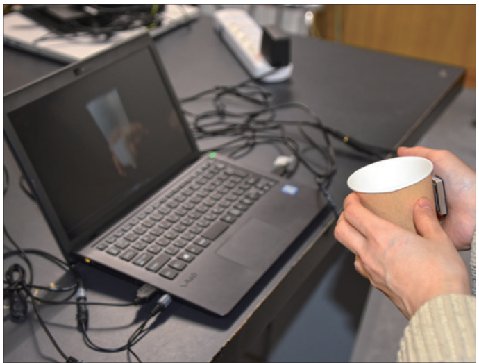
パソコンに映し出されている映像に合わせて温冷感覚や振動感覚が伝わる。
