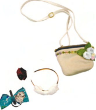
写真2:匂いと行動をロギングする健康管理用IoTポシェット(上)と紫外線を可視化するスマート運動型IoTヘアバンド(下3点)
